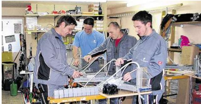
Verdrahtung von elektronischen Komponenten für den Sondermaschinenbau. FOTOS: STN
